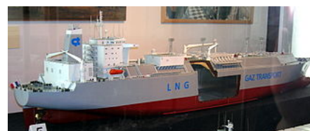
Model of Tanker LNG Rivers , LNG capacity of 135,000 cubic metres
